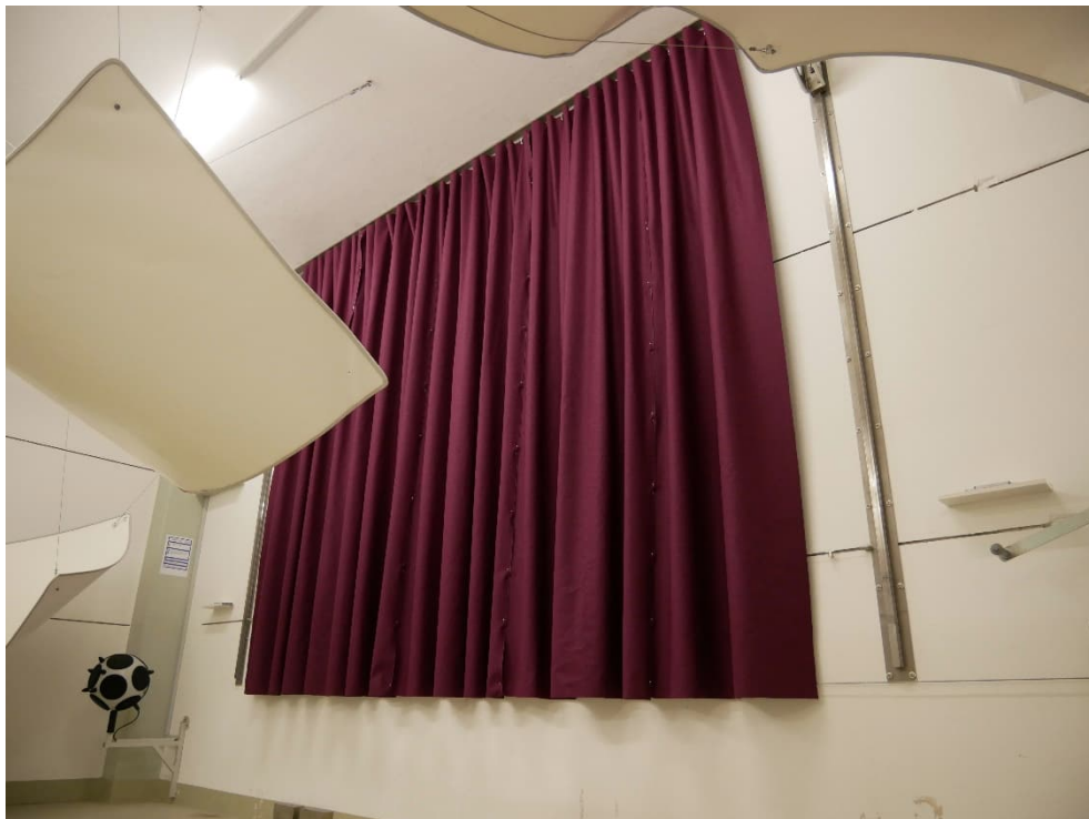
Abbildung B.2. Prüfanordnung im Hallraum (diagonale Ansicht).
