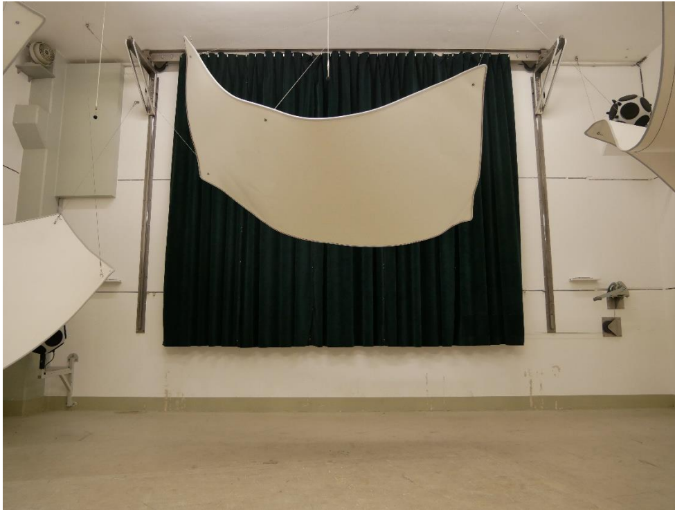
Abbildung B.1. Prüfanordnung im Hallraum (frontale Ansicht).
