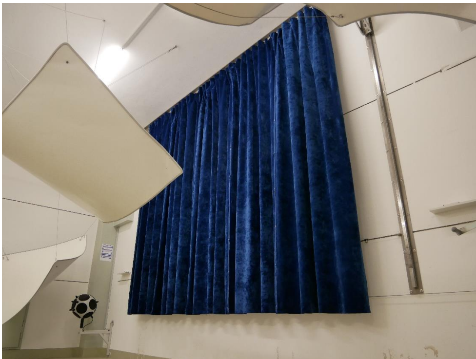
Abbildung B.2. Prüfanordnung im Hallraum (diagonale Ansicht).
