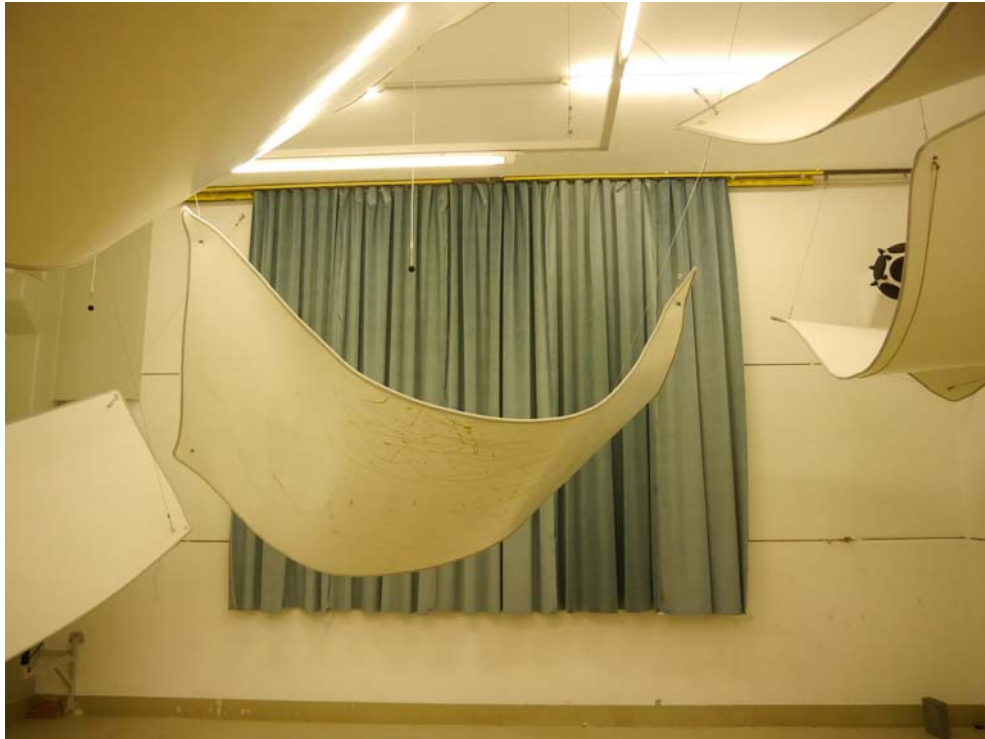
Abbildung B.1. Prüfanordnung im Hallraum: Frontalansicht.
