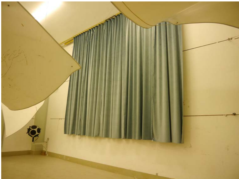
Abbildung B.2. Prüfanordnung im Hallraum: Schrägansicht.
