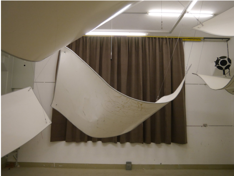
Abbildung B.1. Prüfanordnung im Hallraum: Frontalansicht.
