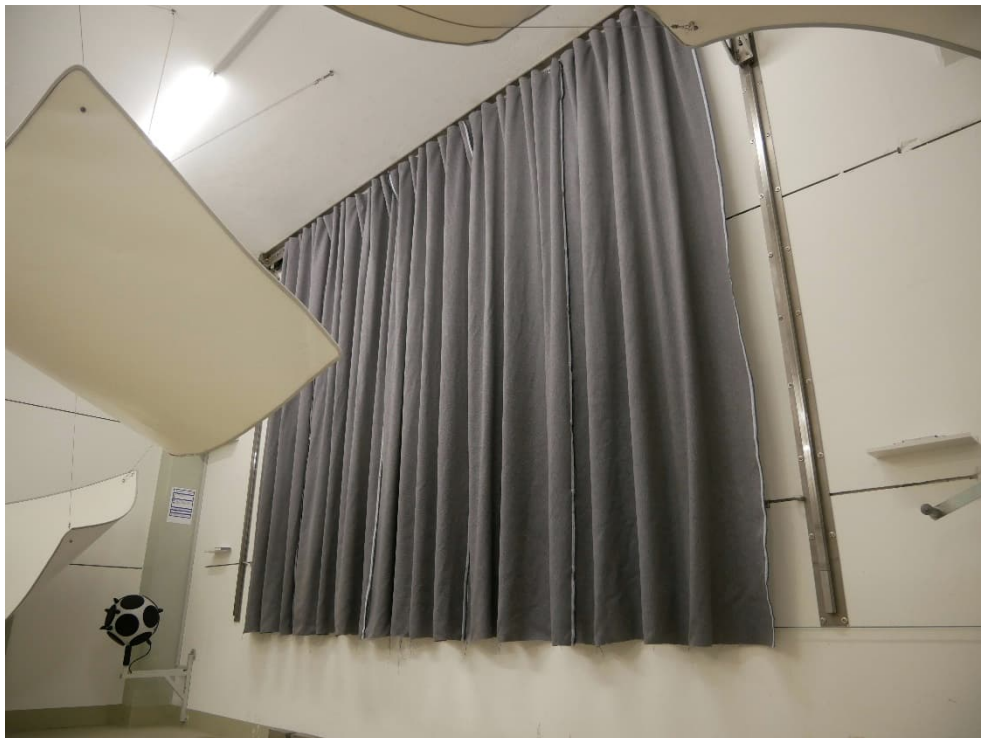
Abbildung B.2. Prüfanordnung im Hallraum (diagonale Ansicht).
