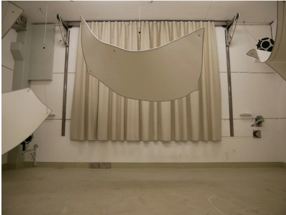
Abbildung B.1. Prüfanordnung im Hallraum (frontale Ansicht).
