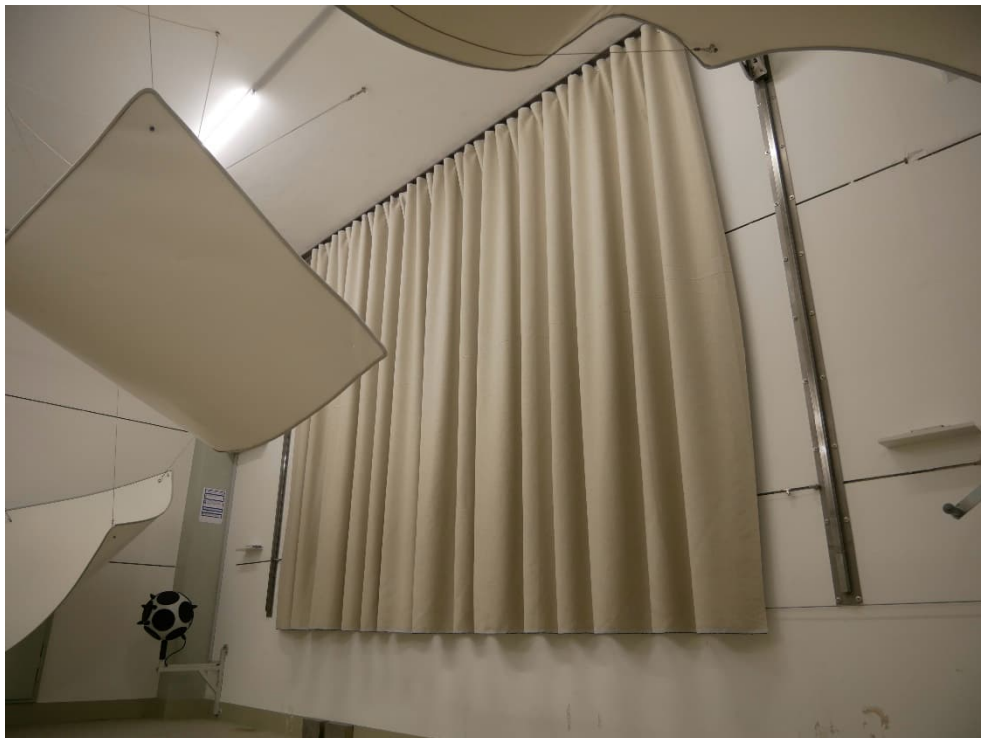
Abbildung B.2. Prüfanordnung im Hallraum (diagonale Ansicht).
