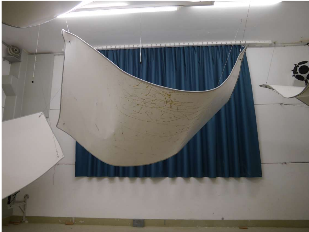
Abbildung B.1. Prüfanordnung im Hallraum: Frontalansicht.
